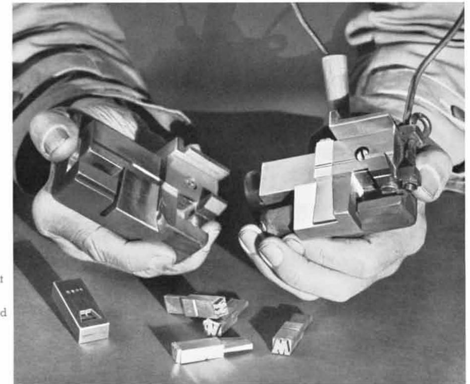
Das Handgießinstrument geöffnet, im Vordergrund Matrize und gegossene Buchstaben mit Anguß
