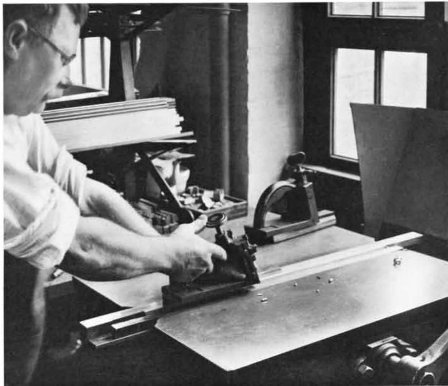
Die auf der Handgießmaschine gegossenen Schriften sind noch nicht gebrauchsfertig, sondern müssen vom Fertigmacher weiter bearbeitet werden. Die Buchstaben besitzen, wie die im alten Handgießinstrument gegossenen Lettern, einen Angußzapfen und Grate an den Kanten des Kegels. Der Anguß wird mit der Hand abgebrochen, bei größeren Graden mit dem Hammer abgeschlagen, während der Grat
