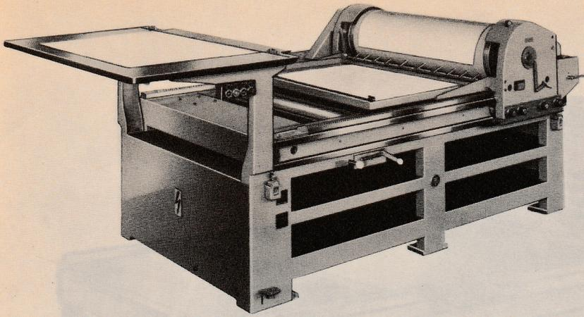
Druckzylinder am Druckende
