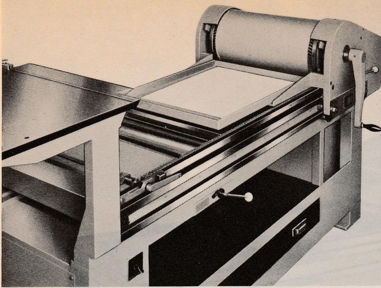
Druckzylinder am Druckende
